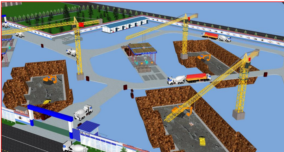
基础工程阶段施工场地布置
